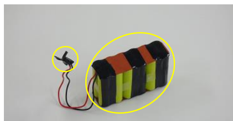
(電池端子連結部当て板の固定 ／コネクター部の被覆)
